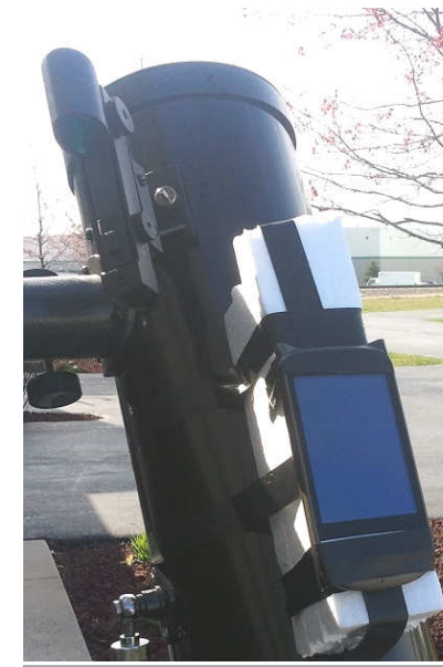
De smartphone gemonteerd op een typische 11cm newtonkijker. Via SkEye verkrijgt men zo héél eenvoudige PushTo-functionaliteit.
